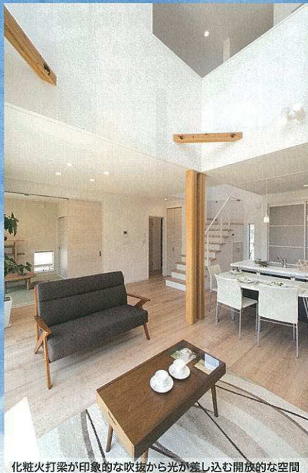
化粧火打梁が印象的な吹抜から光が差し込む開放的な空間
